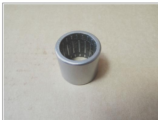
Тип HFL - муфта свободного хода, состоящая из тонкостенной штампованной наружной обоймы со стопорными выступами. Данный тип муфт имеет встроенный подшипник и передает не только крутящий момент, но и позволяет компенсировать радиальные нагрузки. Обгонные муфты HFL оснащаются стальными нажимными пружинами, муфты HFLxxxxKF – нажимными пружинами из пластмассы. Обозначение HFLxxxxR означает, что муфта имеет накатку на наружной обойме для установки в пластиковый корпус.
